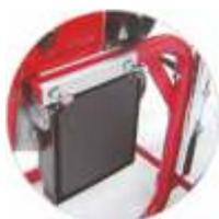
Блок конденсаторов закреплен с боку от двигателя и надежно защищен от возможного повреждения.
